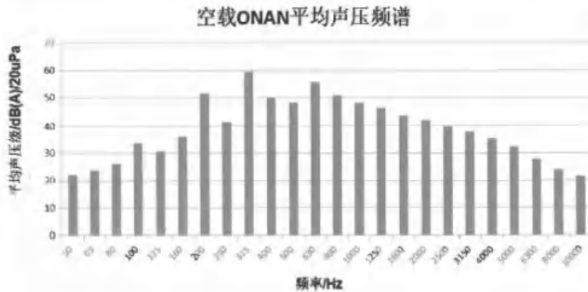
试品声级测量频谱示意图 (空载 ONAN 状态下)
